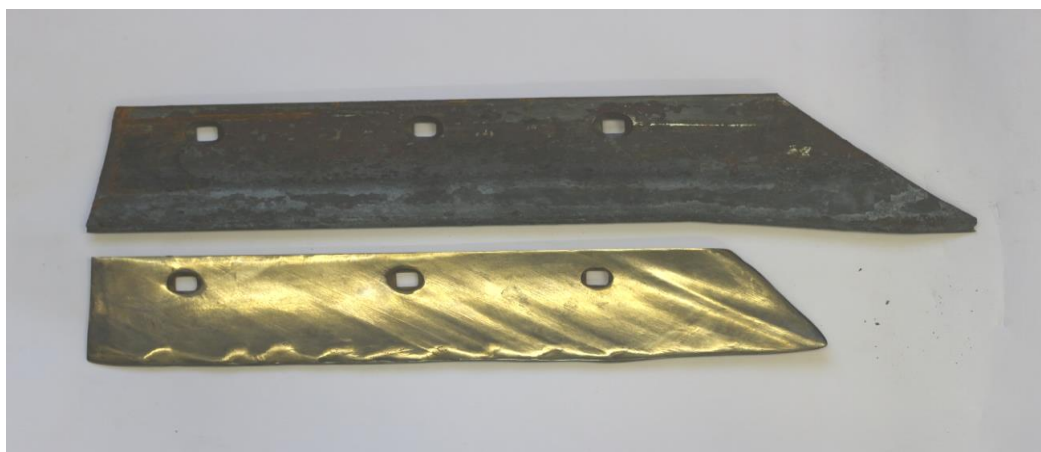
Рис.1. Рабочая поверхность лемеха РЗЗ ПЛЖ 31702 до и после испытаний
